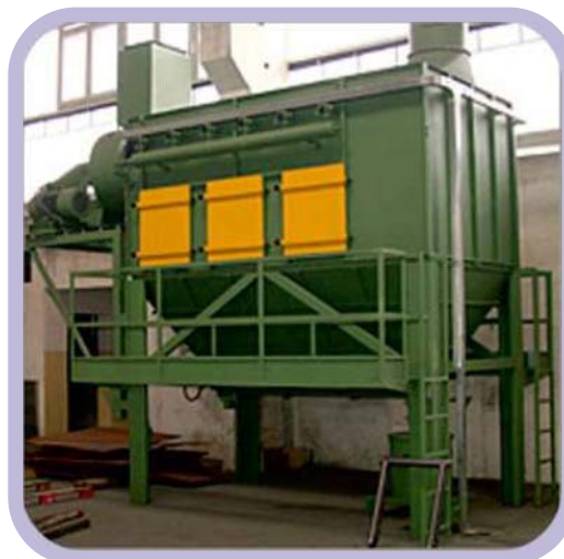
Фильтроустановка тип CDR («STEM» Словения).
